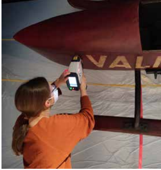
Charlotte Holzer bei der RFA-Messung am Raketen-schlitten RAK BOB 2 von Max Valier (Inv. Nr. 66678).
