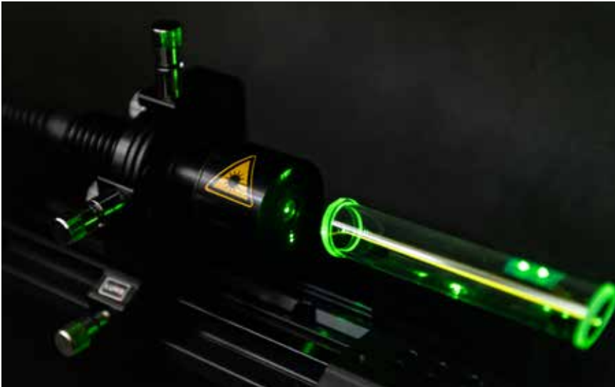
Versuchsaufbau zur resonanten Wechselwirkung von Laserlicht mit Gasmolekülen.
