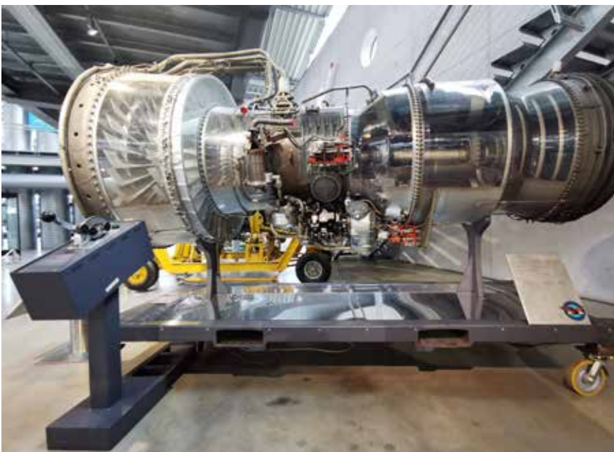
Das geschnittene Zweistromstrahltriebwerk Pratt & Whitney JT3D
